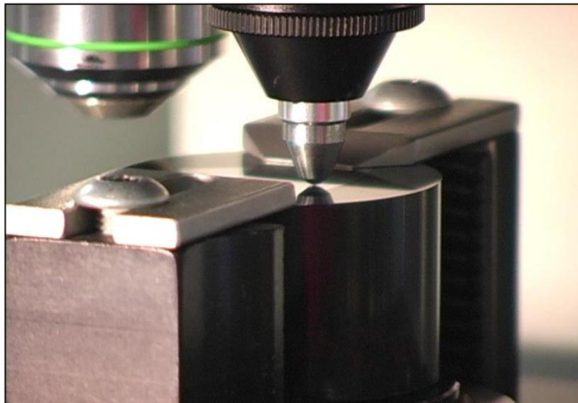
پیج و مهره‌های صایرانیان پیش از فروش و تحویل به مشتری مطابق با الزامات استاندارد و به روش‌های برنیل و راکول (به عنوان روش‌های استاندارد برای کنترل کیفیت قطعاتی نظیر پیج و مهره) سختی سنجی شده و مورد بررسی قرار می‌گیرند.
